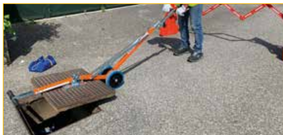
Utilizzo 1: sollevamento con singolo CL10 o CL11. Opzionale
