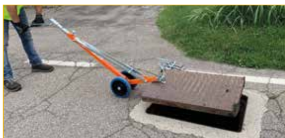
Utilizzo 3: sollevamento con morsetti di bloccaggi opzionali.
